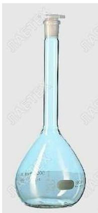
Колбы представляют собой шарообразный сосуд с плоским или незначительно вогнутым дном и длинной цилиндрической горловиной со шлифом.
